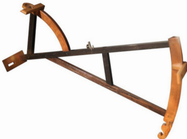
Quartier de Davis 1765, musée de la Marine, Paris [5]. Le quartier de Davis est composé de deux arcs de cercle concentriques sur lesquels coulissent deux pinnules (B et C). En A se situe le « marteau », qui contient une fente. L'observateur déplace B pour voir l'horizon à travers la fente en A. Il déplace C jusqu'à ce que la lumière du Soleil éclaire le marteau A (C contient un « verre ardent » [une lentille]), pour concentrer la lumière. La hauteur du Soleil est égale à la somme des angles mesurés en B et C. Par rapport à ses prédécesseurs (l'astrolabe de marine et l'arbalétrille), l'innovation majeure est que l'observateur tourne le dos au Soleil (d'où son nom anglais : backstaff ) pour ne pas se brûler la rétine. Le quartier de Davis est l'ancêtre de l'octant.
